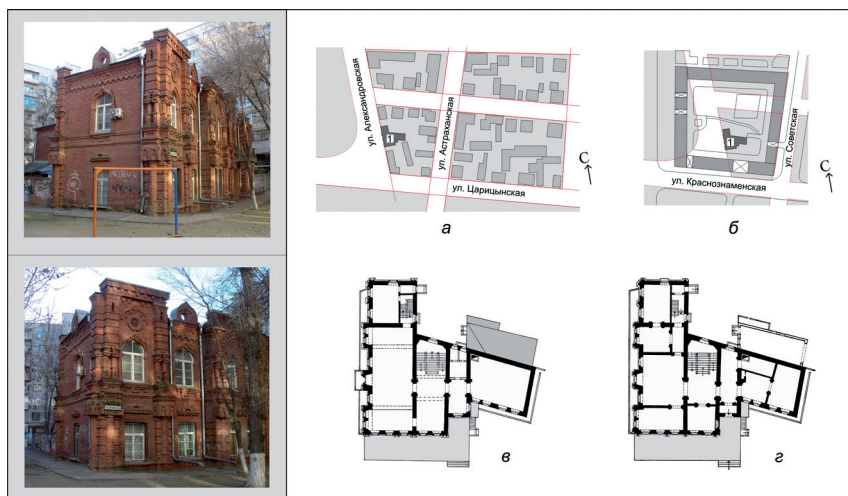
Рис. 2. Архитектурно-планировочная организация жилого дома братьев Рысиных, 1903 г.: а — красные линии — планировочная структура жилых кварталов Царицына — Сталинграда до 1943 г.; в — совмещение планировочных структур жилых кварталов Царицына — Сталинграда — Волгограда; в, з — план 1-го и 2-го этажей
